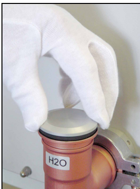
Insert dummy plug.
