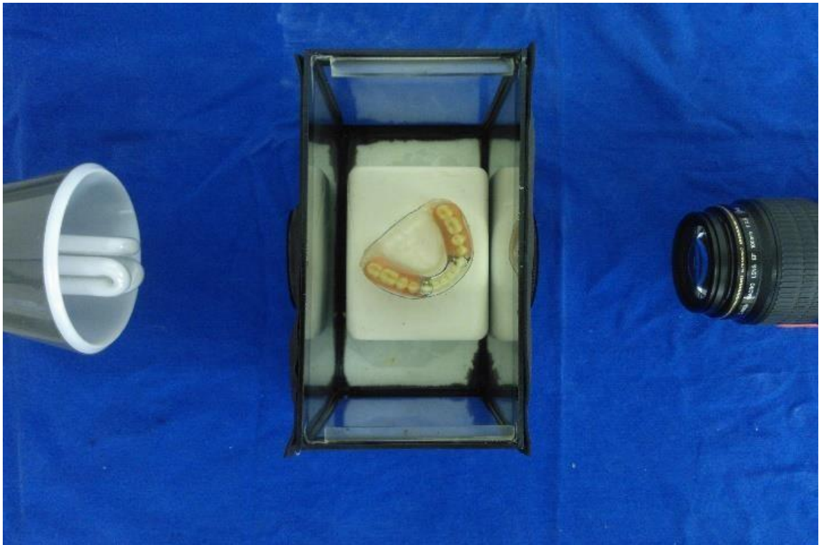
Figura 9- Polariscópio de transmissão com o modelo posicionado à 45°.
