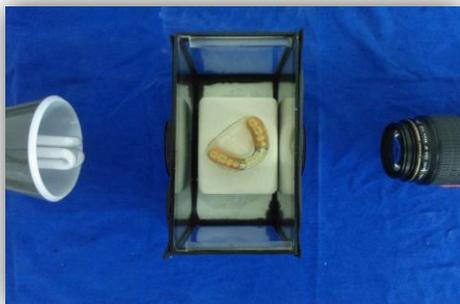
Figura 7 – polariscópio de transmissão com o modelo posicionado à  $45^\circ$
