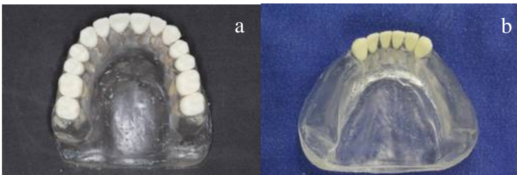
Figura 3. Modelo Fotoelástico: a) Modelo Fotoelástico da Maxila; b) Modelo Fotoelástico da Mandíbula.
