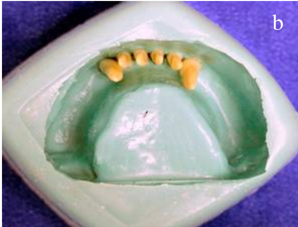
Figura 3. Modelo Fotoelástico: a) Modelo Fotoelástico da Maxila; b) Modelo Fotoelástico da Mandíbula.
