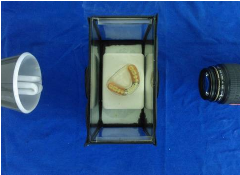
Figura 11. Polariscópio de transmissão com o modelo posicionado a 45°.
