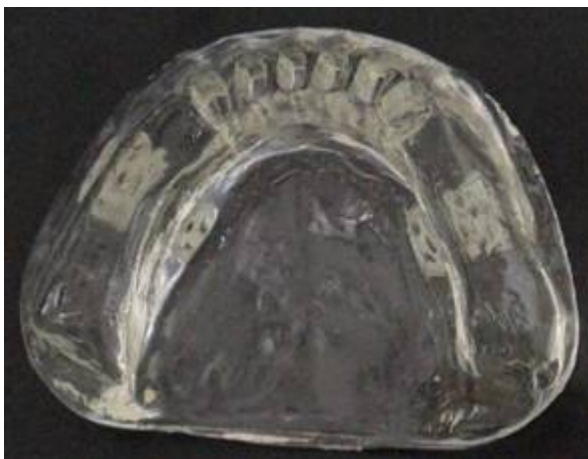
Figura 4. Corpo de prova em resina fotoelástica, sendo confeccionados 21 modelos para o delineamento dos grupos de estudo: Grupo cíngulo total (GCT)(n=7); grupo cíngulo parcial (GCP)(n=7); grupo sem nicho (GSN)(n=7).
