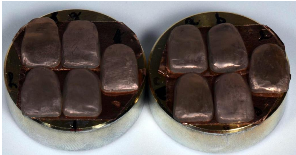
Figura 5 – Amostras recobertas com ouro
