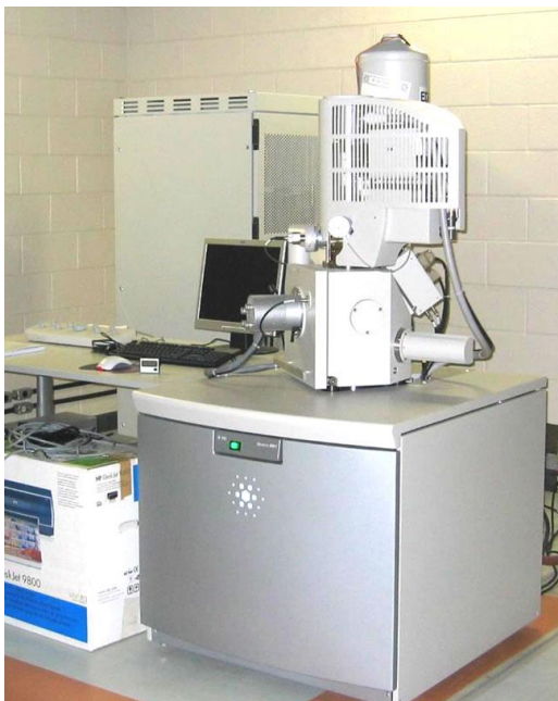
Figura 4. Microscópio Eletrônico de Varredura (MEV) da marca FEI, modelo Quanta 200.
