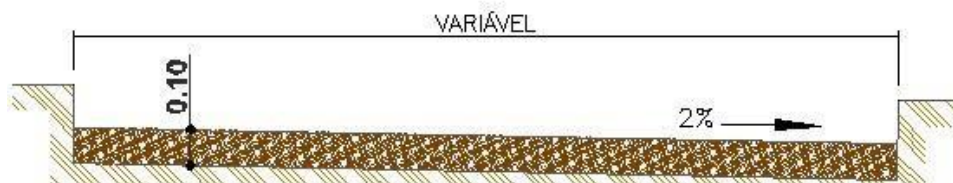
FASE 2: EXECUÇÃO DA SUB-BASE DO PAVIMENTO DA CICLOVIA (REATERRO)
