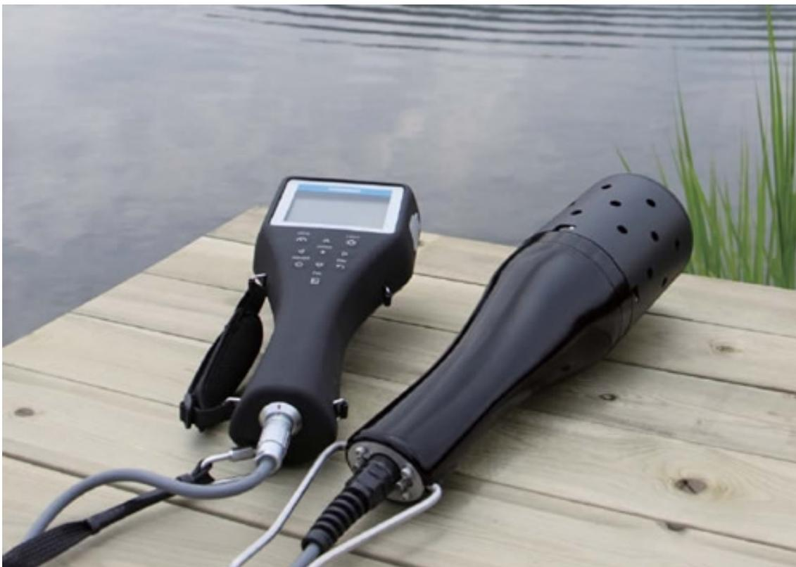
**Figura 10 - Equipamento Horiba U-50 utilizado para obtenção de dados em campo. Fonte: HORIBA, 2012.**
