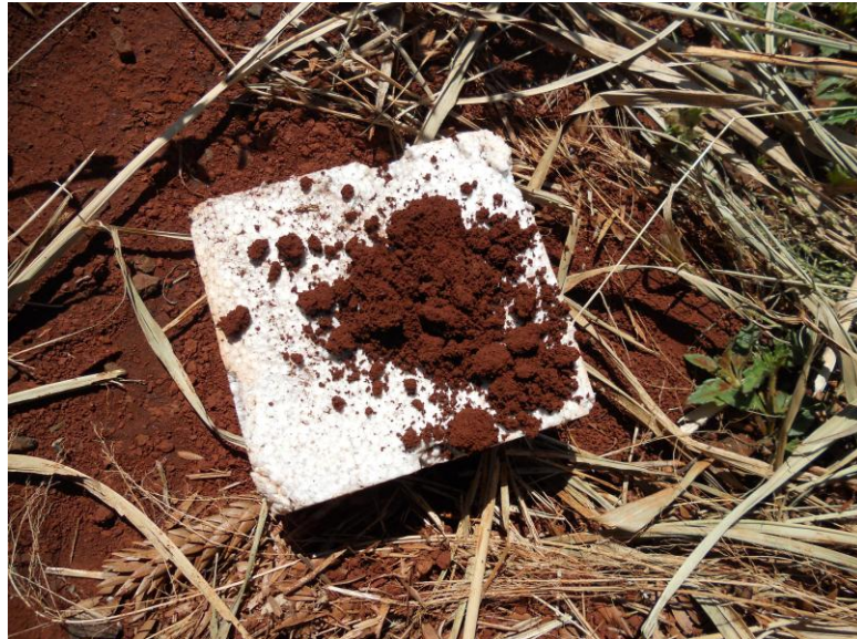
Figura 9 - Estrutura em "pó de café" encontrada no horizonte B-latossólico do perfil estudado. Fonte: Pedro Höfig, 2012.
