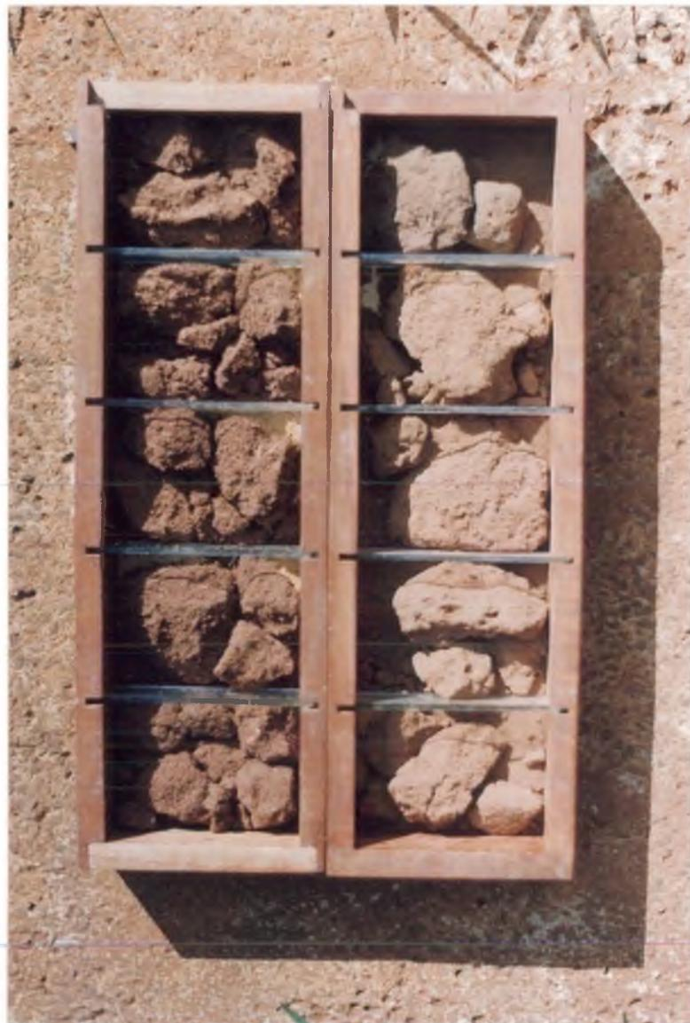
FOTO 10: Monólito de solos. Esquerda: Latosol Vermelho Escuro-LE. Direita: Podzólico Vermelho Escuro-PE. Pontos 1 e 2 assinalados na carta de solos. Coleta efetuada durante trabalho de campo com os cooperados da COPAVI. Foto: Omar Neto Fernandes Barros.
